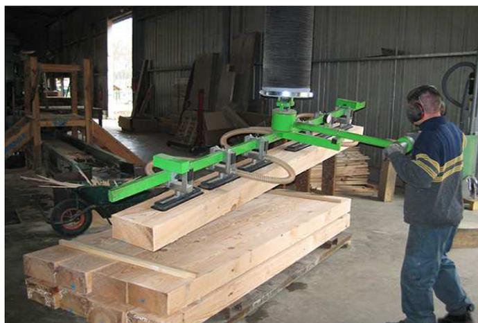
← Le Clad Lift permet à un seul opérateur de poser des menuiseries jusqu'à 350 kg sans se fatiguer dans de nombreuses situations, grâce au bras télescopique capable de faire une rotation à 360°. Ce robot est particulièrement adapté aux travaux lourds dans l'industrie et sur les chantiers.
