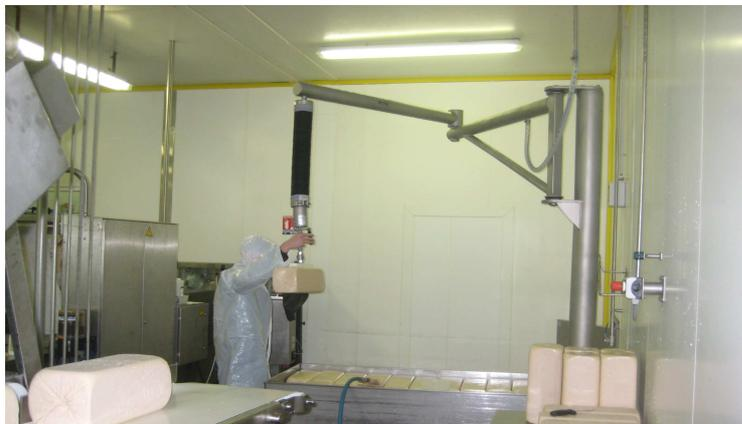
La potence satellite est composée de 2 bras articulés avec possibilité du passage du vide en interne. Elle nécessite une bonne qualité de sol pour sa fixation Elle peut être déclinée en acier ou, en fonction du poids, en inox.
