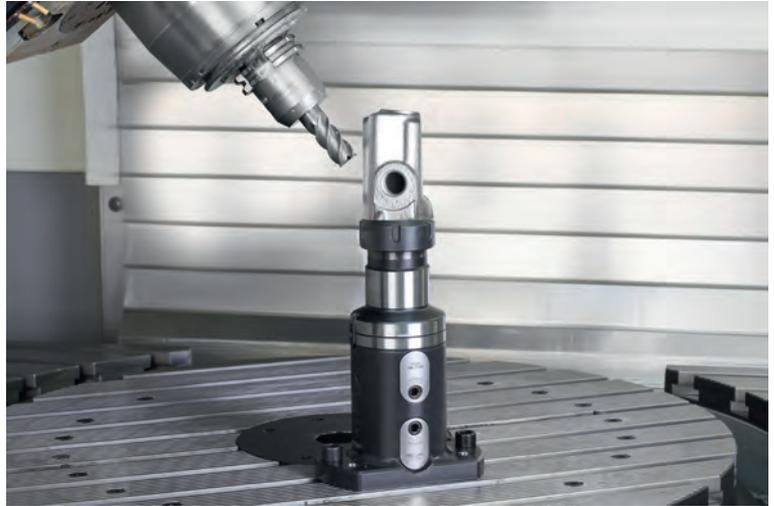
Carter de transmission monté sur 3 modules de base, 3 éléments de bridage et 3 adaptateurs réducteurs. Le carter en fonte se visse aux adaptateurs au moyen de vis cylindriques.
