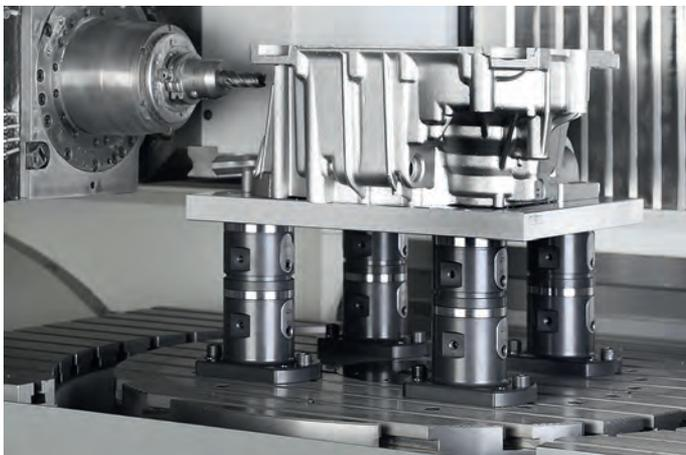
Plaque de montage avec carter de transmission sur 4 modules de base et éléments de bridage. La plaque de montage est vissée aux éléments au moyen de 4 tenons de fixation.
