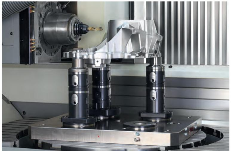
Carter de transmission avec 3 modules de base, 3 éléments de bridage et 3 adaptateurs réducteurs. Le carter en fonte se visse aux adaptateurs au moyen de 3 vis cylindriques. Usinage du 6ème axe possible grâce à la tête coudée.
