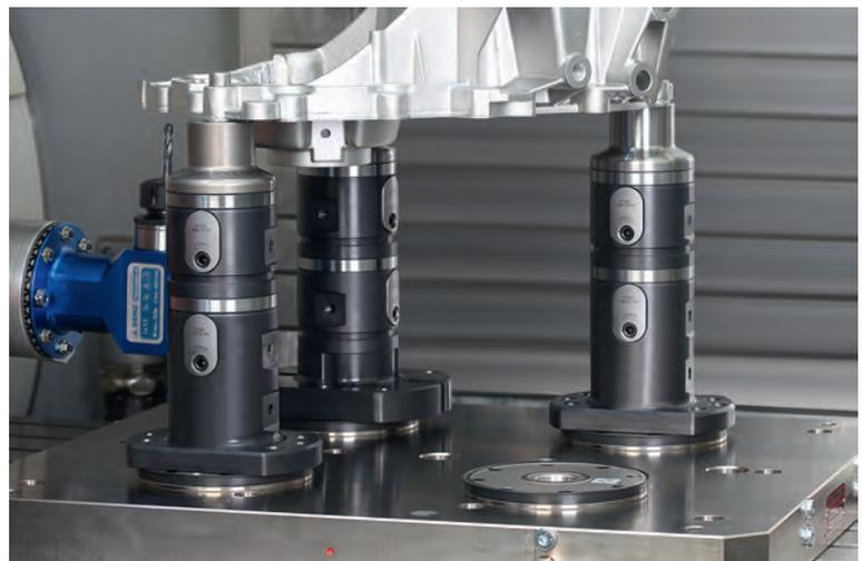
Pièce pleine montée sur 4 modules de base et 4 éléments de bridage.
