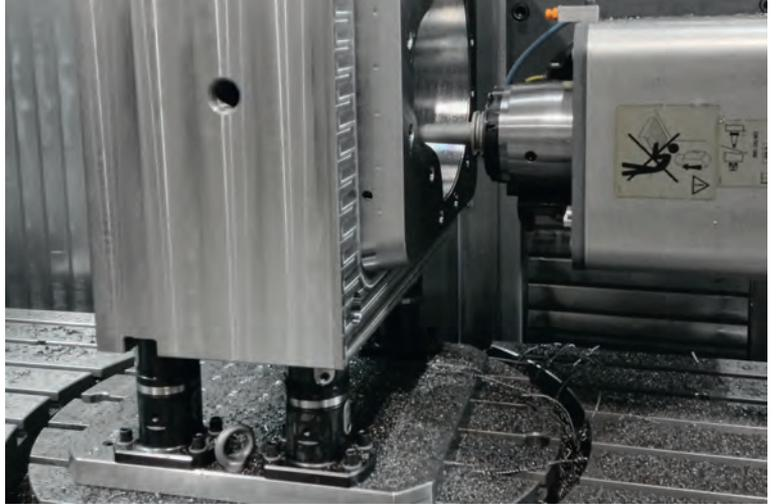
2 modules de base avec un tenon de centrage directement adapté sur un système de bridage point zéro.
