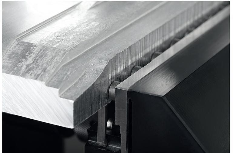
Pièce brute après processus de serrage. Empreinte de la pointe de serrage visible sur le contour de la pièce à usiner ayant été serrée.
