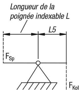
Force de serrage effective  $F_{Sp}$  fonction de la force du piston  $F_{Kol}$  et de la longueur de la poignée indexable  $L$
