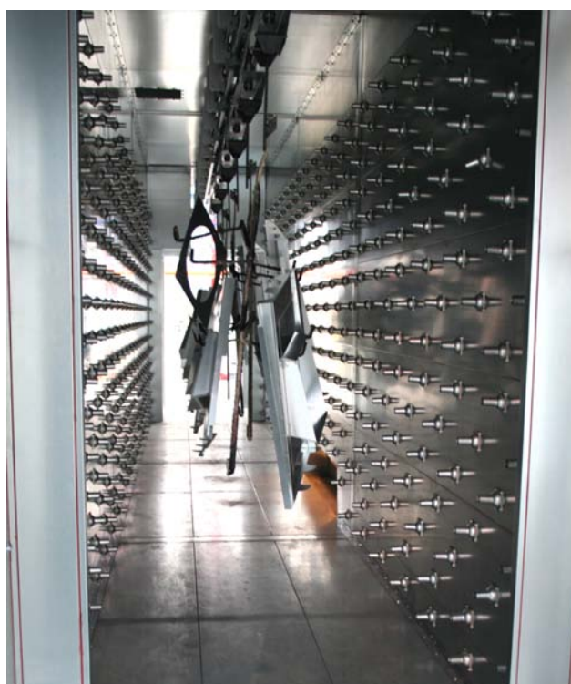
Séchage après tunnel de dégraissage Drying after degreasing tunnel
