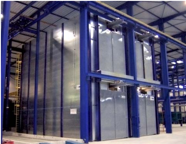
Séchage peinture électrophorèse et cuisson poudre Electrophoresis paint drying and powder baking
