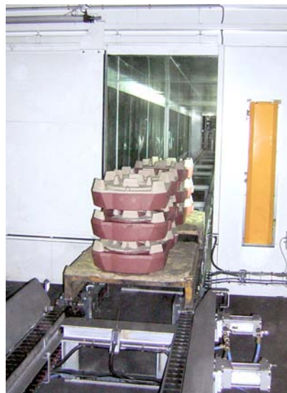
Déshydratation moules de fonderie Dehydration of foundry moulds
