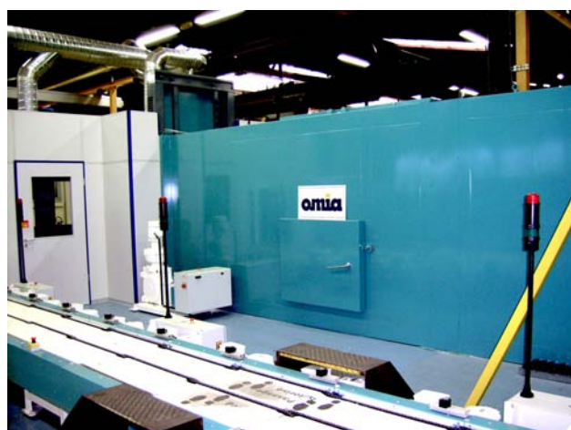
Tunnel de polymérisation avec convoyeur à plateaux Polymerization tunnel with platforms conveyor
