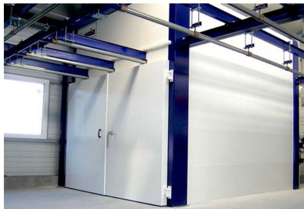
Polymérisation poudre Powder polymerization
