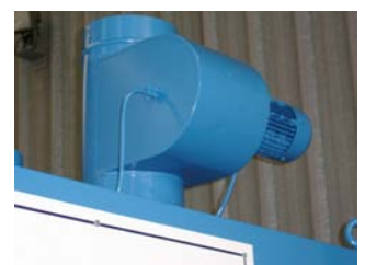
Extracteur avec contrôle de ventilation Extractor with ventilation control
